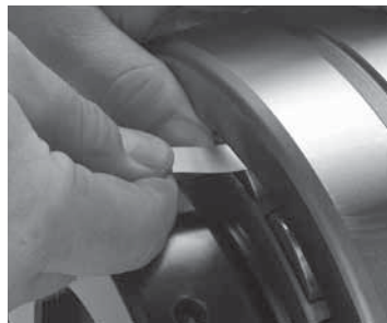
Рис. 18. Измерение РВЗ до монтажа.
