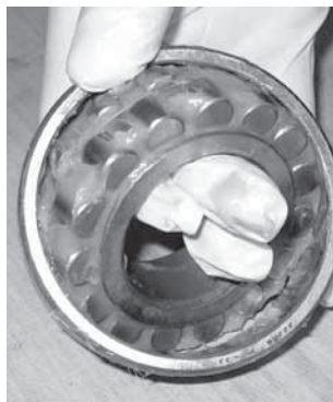
Рис. 21. Пластичная смазка позволяет легко заправить подшипник вручную.
