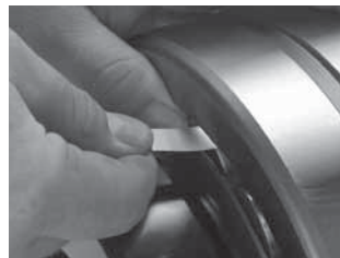
Рис. 14. Измерение РВЗ в домонтажном состоянии.
