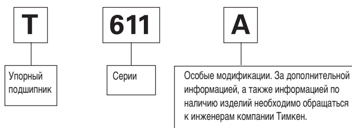
Рис. 41. Система обозначений упорных конических подшипников.
