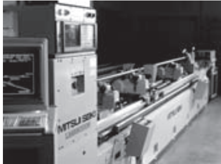
Лазерная автоматическая установка для измерения шага резьбы
