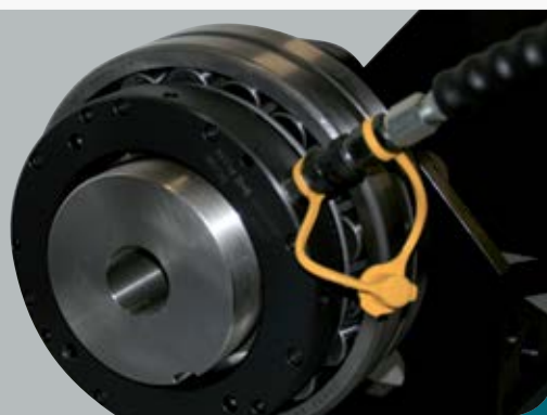
Снятие стяжной втулки с помощью гидравлической гайки
