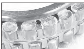
Рис. 2: Цилиндрический роликоподшипник в смазке
