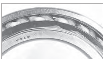
Рис. 1: Радиальный упорный шарикоподшипник в смазке
