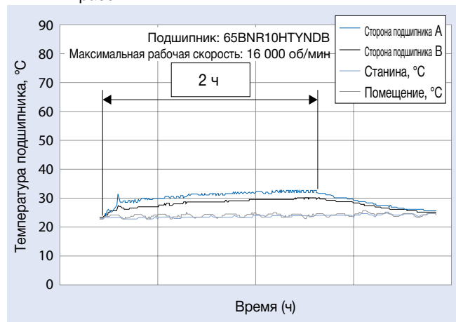
Рис. 3.3 Изменение температуры при прерывистом режиме работы
