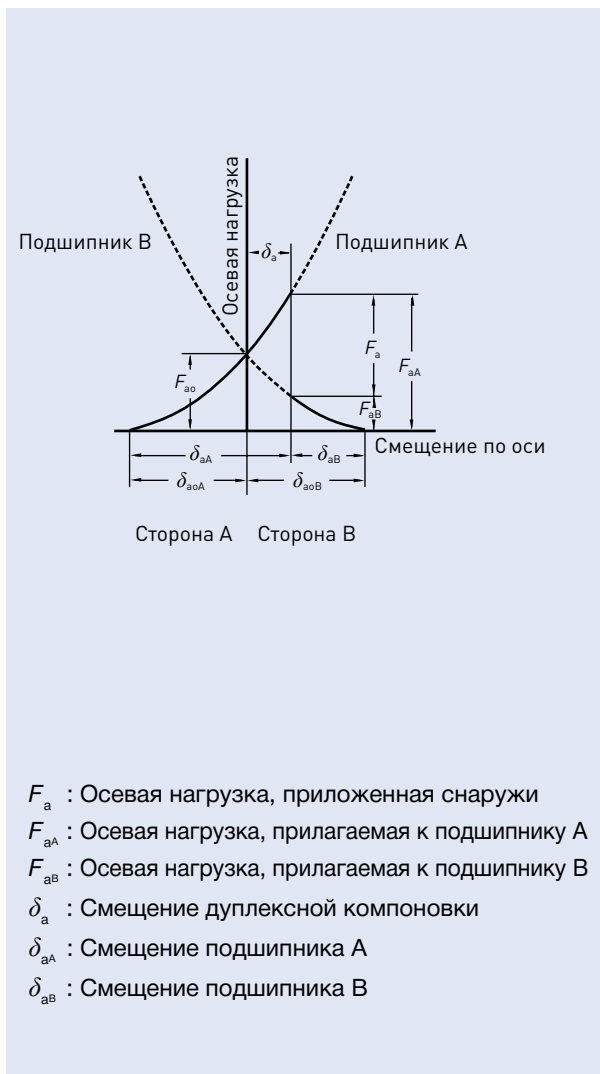
Рис. 4.4 Смещение по оси компоновки DB с преднатягом
