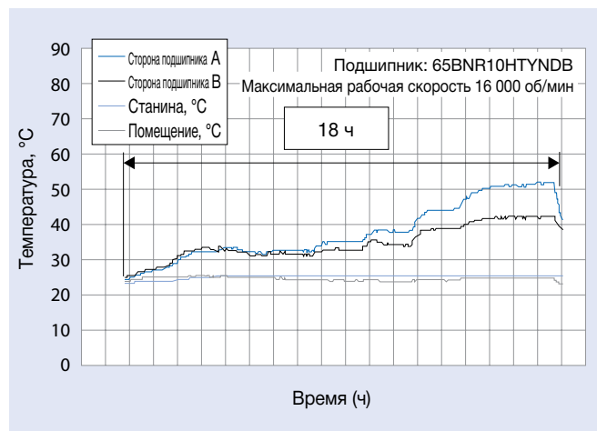
Рис. 3.1 Изменения температуры при работе с постоянной скоростью
