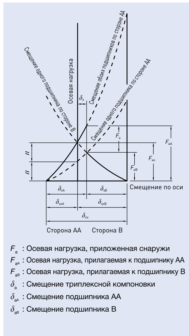
Рис. 4.6 Смещение по оси компоновки DBD с преднатягом
