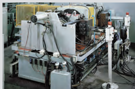
Испытательный стенд для подшипников, использующихся в рабочих валках прокатных станов
