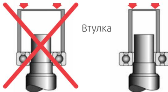
Подшипник можно повредить, если при установке монтажное усилие прилагается не на соответствующее кольцо. В частности, на шариках или дорожках качения могут появиться насечки, так называемое «бринеллирование».
