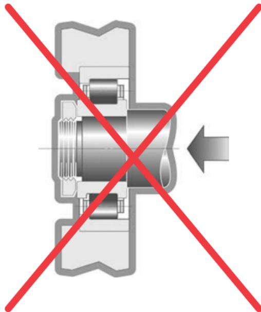
Трещины на кольцах, вызванные применением ударной нагрузки при посадке подшипника
