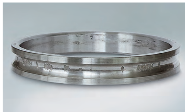
Фото 1.4 Деталь: Внутреннее кольцо радиально-упорного шарикового подшипника Симптом: Усталостное отслаивание следов вращения, соответствующее шагу шариков Причина: Выбоины в результате ударной нагрузки в неподвижном состоянии
