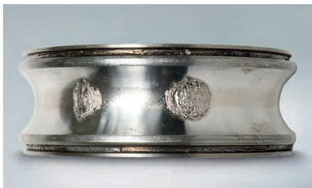
Фото 1.3 Деталь: Внутреннее кольцо радиального шарикового подшипника Симптом: Усталостное отслаивание следов вращения, соответствующее шагу шариков Причина: Выбоины в результате ударной нагрузки при монтаже
