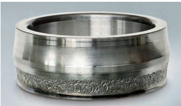
Фото 1.7 Деталь: Внутреннее кольцо подшипника качения со сферическими роликами Симптом: Усталостное отслаивание только одного следа вращения по всей периферии Причина: Чрезмерная осевая нагрузка
