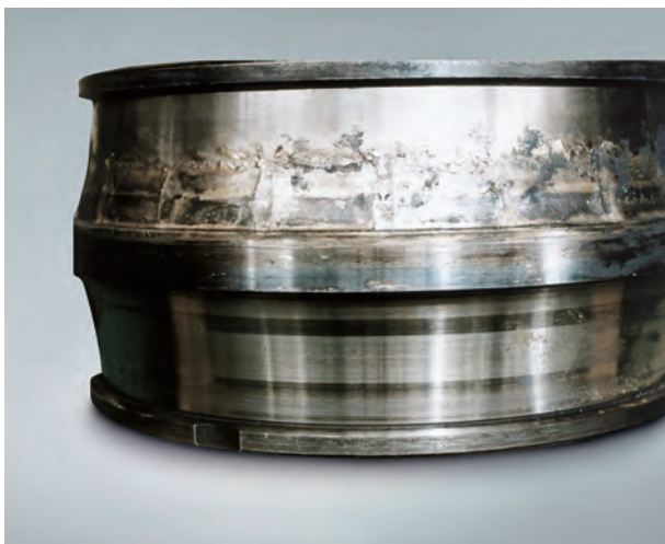
Фото 14.1 Деталь: Внутреннее кольцо подшипника качения со сферическими роликами Симптом: Дорожка качения изменила цвет и оплавилась. Частицы изнашивания сепаратора прилипли к дорожке качения Причина: Недостаточная смазка
