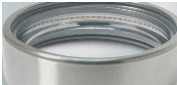
Фото 15.6 Деталь: Наружнее кольцо шарикового подшипника Симптом: Рефление на поверхности следов вращения (Высокой частоты)
