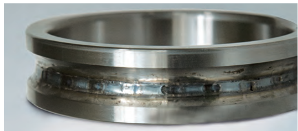
Фото 14.3 Деталь: Внутреннее кольцо радиально-упорного шарикового подшипника Симптом: Изменение цвета следов вращения, оплавление на интервале, соответствующем шагу шариков Причина: Чрезмерный предварительный натяг
