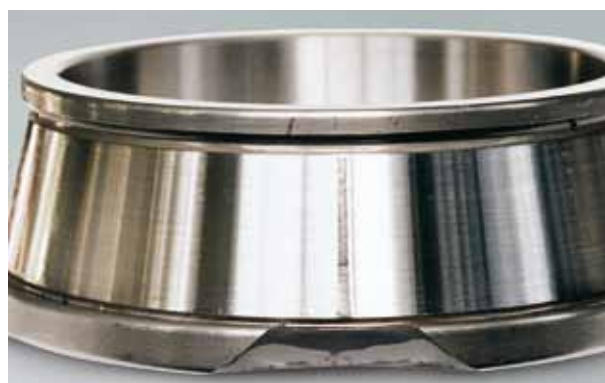
Фото 5.2 Деталь: Внутреннее кольцо конического роликоподшипника Симптом: Скол на буртике конической поверхности Причина: Сильное ударное воздействие в процессе монтажа
