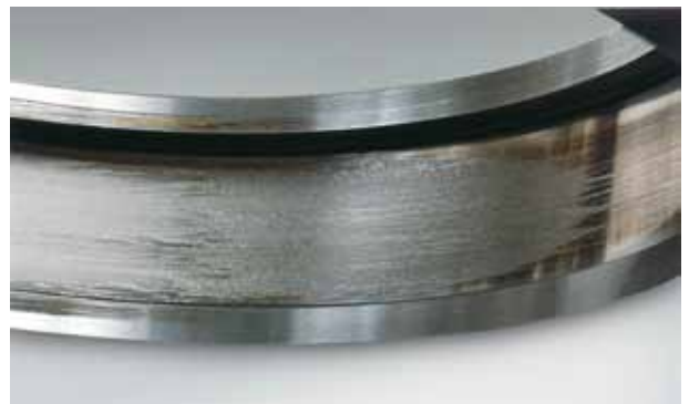
Фото 4.2 Деталь: Наружное кольцо с фото 4.1 Симптом: Размазывание по периферии поверхности следов вращения Причина: Проскальзывание роликов вследствие избыточного количества пластичной смазки
