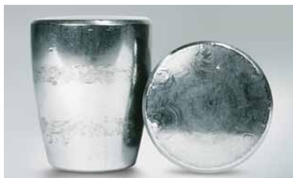
Фото 3.6 Деталь: Бочкообразные ролики с фото 3.5 Симптом: Задиране на краю ролика Причина: Частицы износа, попадающие на поверхность, и чрезмерная осевая нагрузка
