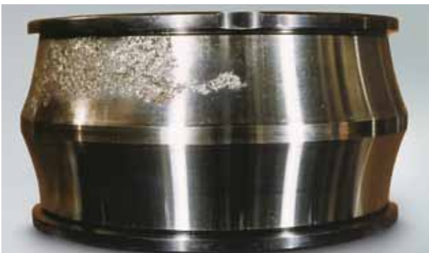
Фото 1.9 Деталь: Внутреннее кольцо подшипника качения со сферическими роликами Симптом: Усталостное отслаивание только одного ряда следов вращения Причина: Недостаточная смазка
