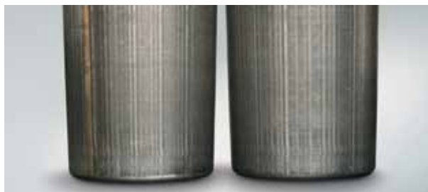
Фото 15.2 Деталь: Бочкообразные ролики с фото 15.1 Симптом: Полосовой характер коррозии на поверхности ролика
