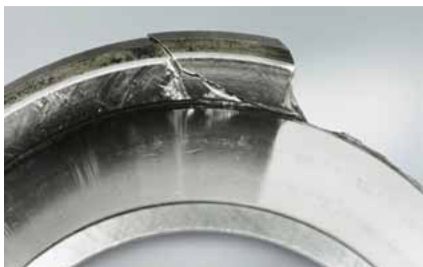
Фото 5.3 Деталь: Внутреннее кольцо сферического упорного роликоподшипника Симптом: Скол на большом буртике Причина: Многократно повторяющаяся нагрузка
