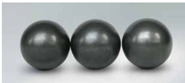
Фото 15.4 Деталь: Шарики радиального шарикового подшипника Симптом: Электрохимическая коррозия придает темный цвет всей поверхности шариков
