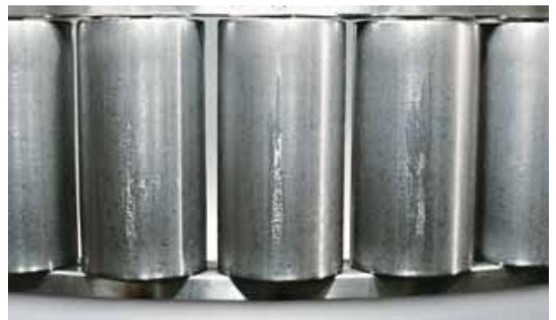
Фото 1.10 Деталь: Ролики цилиндрического роликового подшипника Симптом: Преждевременное усталостное отслаивание в осевом направлении поверхности ролика Причина: Царапины, вызванные неправильным монтажом
