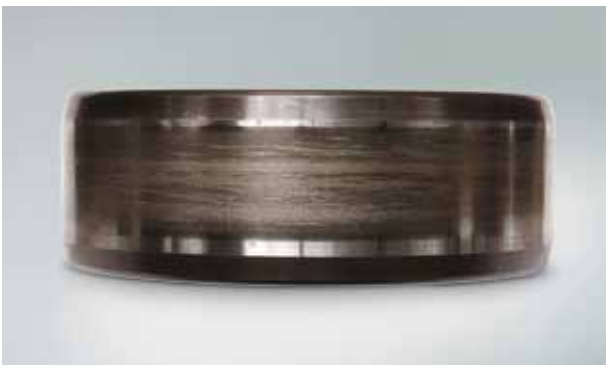
Фото 4.1 Деталь: Внутреннее кольцо подшипника качения с цилиндрическими роликами Симптом: Размазывание по периферии поверхности следов вращения Причина: Проскальзывание роликов вследствие избыточного количества пластичной смазки
