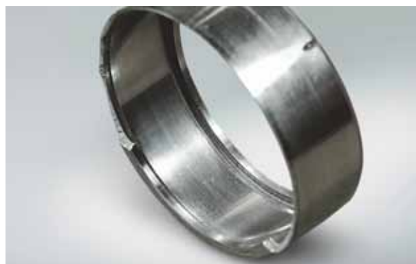
Фото 5.4 Деталь: Наружное кольцо радиального роликоподшипника с игольчатыми роликами Симптом: Скол на буртике наружного кольца Причина: Наклон роликов вследствие чрезмерной нагрузки (Игольчатые ролики имеют большую длину в сравнении с диаметром. При чрезмерной или неравномерной нагрузке ролики наклоняются и оказывают давление на буртики.)
