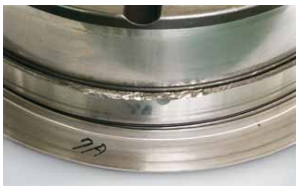
Фото 5.1 Деталь: Внутреннее кольцо двухрядного цилиндрического роликоподшипника Симптом: Скалывание в центре буртика Причина: Чрезмерная нагрузка в процессе монтажа
