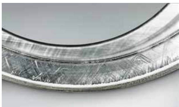
Фото 3.5 Деталь: Внутреннее кольцо сферического упорного роликоподшипника Симптом: Задиране на поверхности внутреннего кольца Причина: Частицы износа, попадающие на поверхность, и чрезмерная осевая нагрузка
