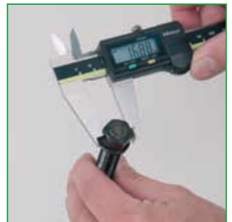
d Messen Sie den Sechskant des Spindelkopfes. Measure the hexagon of the spindle head.
