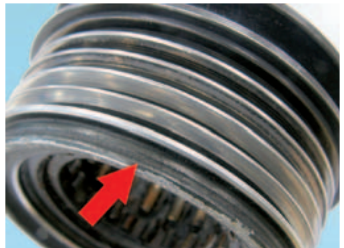
Fig. 14: Guide edge abraded
