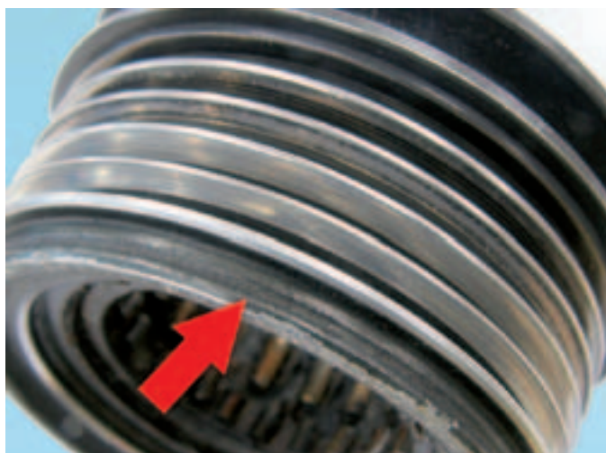
Fig.14 : Bord de guidage usé
