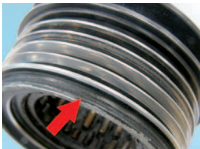
Fig.14: Bordes de guía desgastados
