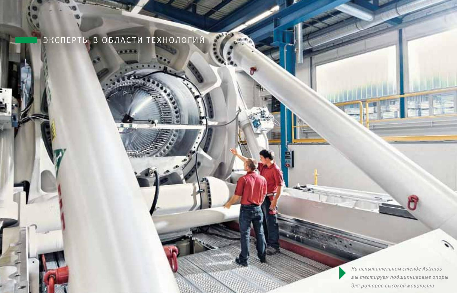
▶ На испытательном стенде Astraios мы тестируем подшипниковые опоры для роторов высокой мощности
