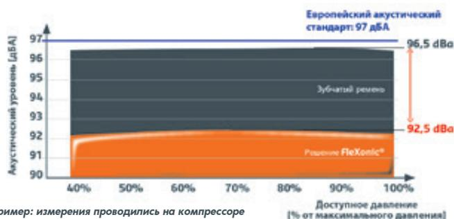
Пример: измерения проводились на компрессоре
