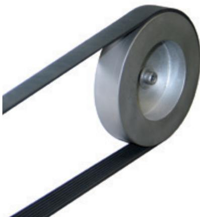
Гладкие шкивы могут приводиться в движение продольными ребрами ремня **Poly V®**. Тем не менее, контактная поверхность гладкого шкива меньше, чем у бороздчатого шкива, и следует соблюдать определенные меры предосторожности при проектировании ременной трансмиссии.
