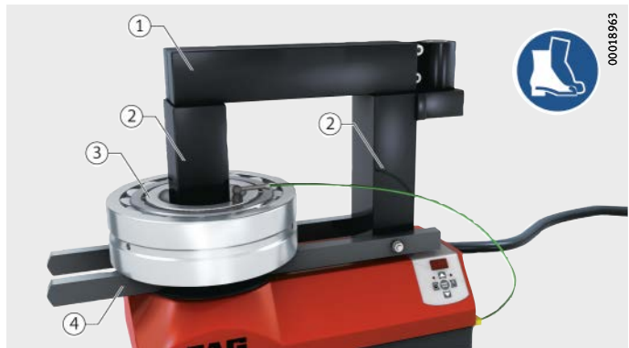
Рисунок 22 Подшипник качения, уложенный горизонтально
